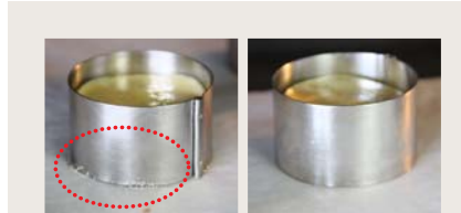
砂糖品は枠から油が染み出しているが、トレハ品は油が染み出していない。
